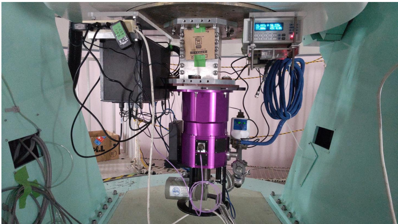
1m 望遠鏡に取り付けられた KUIRCAM2
