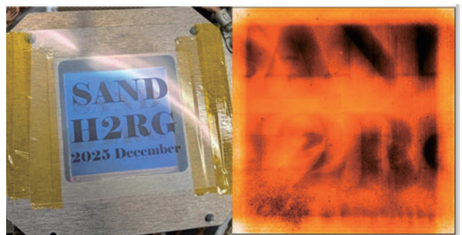
図：検出器に文字の影を映した動作確認画像。右図で暗くなっている部分が文字の影になっている。
