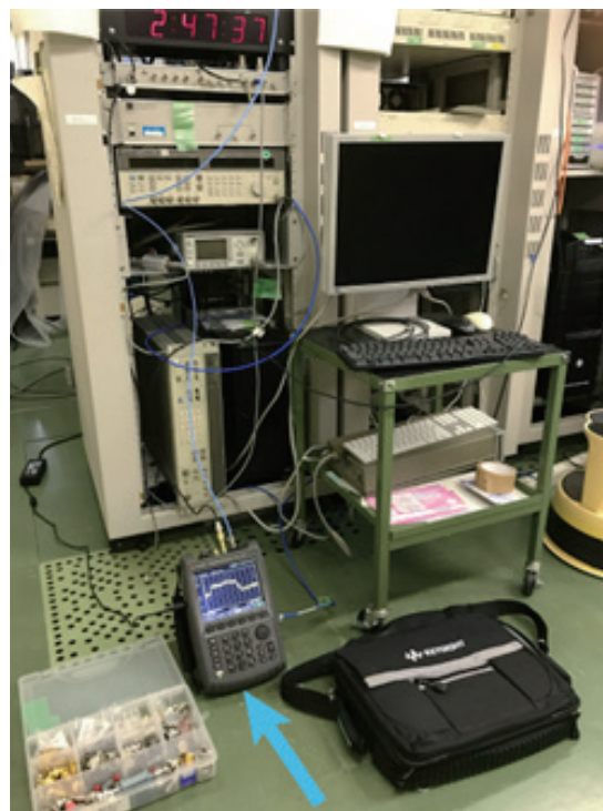
写真1：鹿児島大学の備品となっている携帯スペアナ（水色矢印）とそれを取り巻く VLBI バックエンド機器。2025 年 2 月 17 日野辺山宇宙電波観測所にて撮影。電気回路分析機能（電気信号の透過や反射等を計測する機能）及びベクトル電圧計測機能（2つの交流電気信号間の振幅比及び位相差を計測する機能）も有する。
